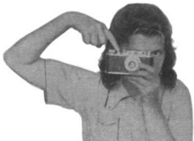
Рис. 15. Неправильное горизонтальное положение аппарата
